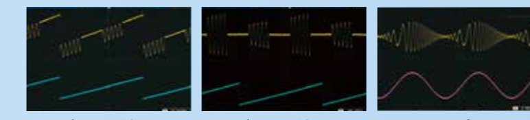
バースト発振を立ち上がりランプ波でDCオフセット変調
