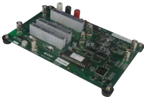
本器は、位相検波モジュール CD-552 シリーズを用いた直交位相検波の結果から、入力信号中の参照信号と同期した成分の振幅と位相を DSP により算出し、アナログ電圧として出力することができます。
