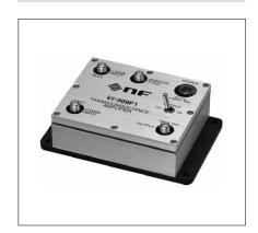
VI-309F1は、利得の異なる2つの入力を持つ電圧電流変換モジュールです。最大10Ω の負荷抵抗に対して±50mAまでの電流を安定して供給することができます。入力端子 H-GAIN INPUTは変換利得5mA/V、L-GAIN INPUTは変換利得50  $\mu$ A/Vです。両入力 とも周波数帯域はDCから10kHzです。
