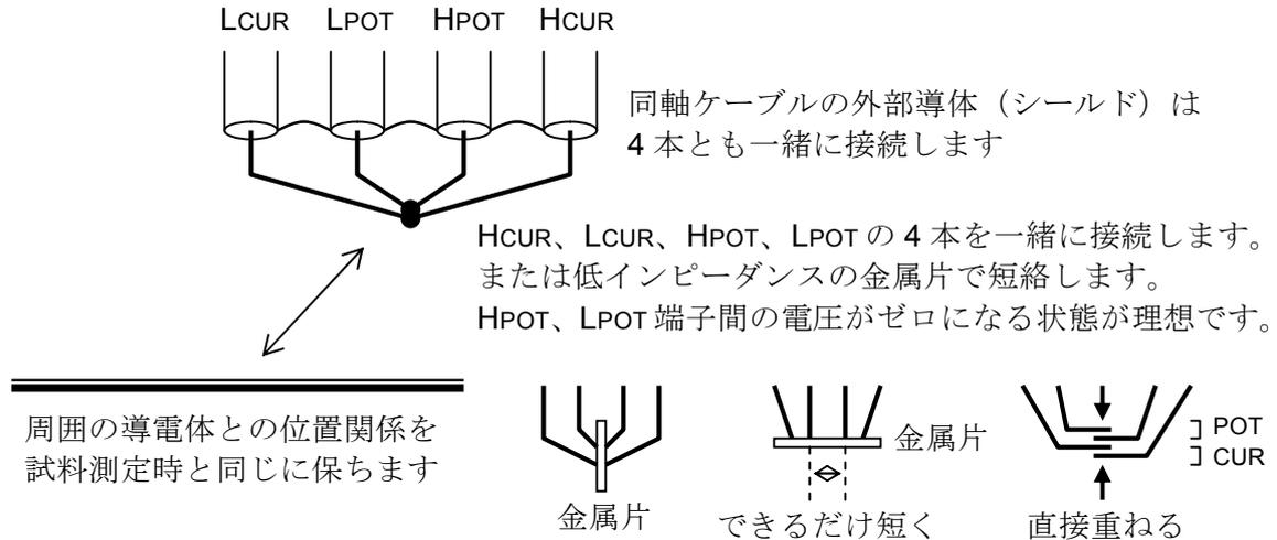
ケーブルの位置関係、特に HCUR-LCUR 電流ループと、HPOT-LPOT 電圧ループの関係を試料測定時と同じに保ちます。ループはできるだけ小さくして、電磁結合を低減します。
