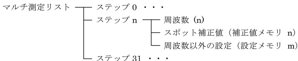
マルチ測定のステップ n では、リストに登録された周波数(n)で測定が行われます。また、補正值メモリ n からオープン / ショート / ロードの各スポット補正值を復帰します。周波数以外の設定、たとえば信号レベルや合否判定の上下限值は、リストで対応付けた任意の設定メモリ m から復帰します。
