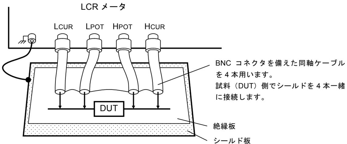
雑音の混入で測定値が不安定になるときは、測定ケーブルの外部導体 (シールド) または筐体に接続した金属板を下に敷くなどしてシールドすると効果があります。
