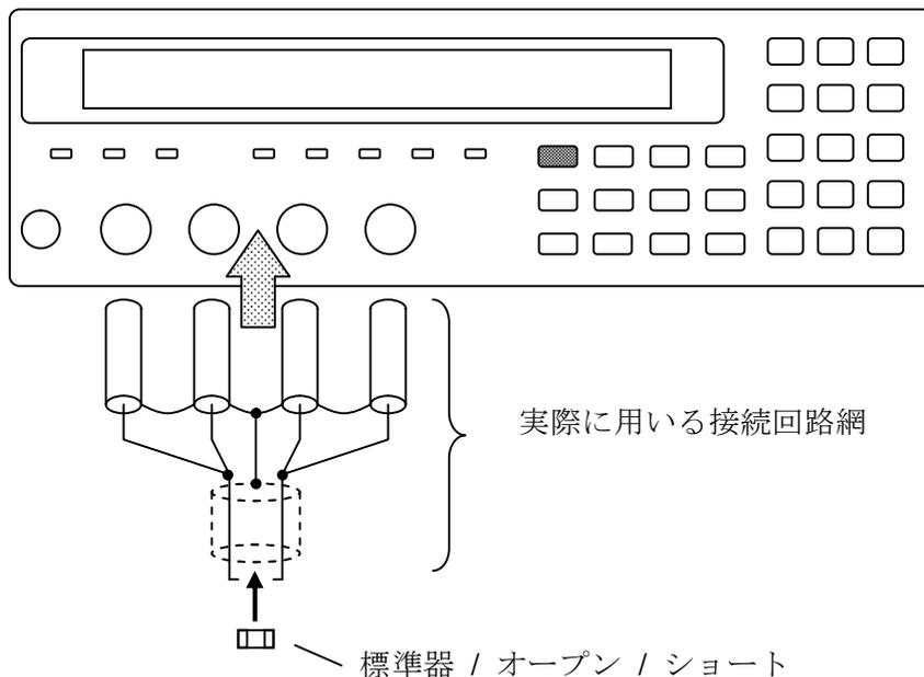
図 3-12 ロード補正値の測定
