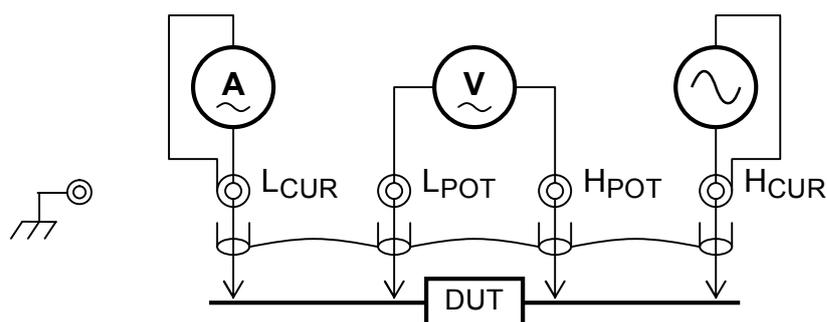
各端子の外部導体 (シールド) は 4 本いっしょに接続します。信号電流の帰還経路になるので、HCUR 端子と LCUR 端子の外部導体 (シールド) は、必ず接続してください。
