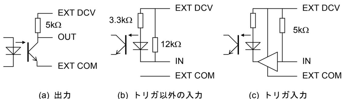
図 4-5 ハンドラインタフェースの等価回路
