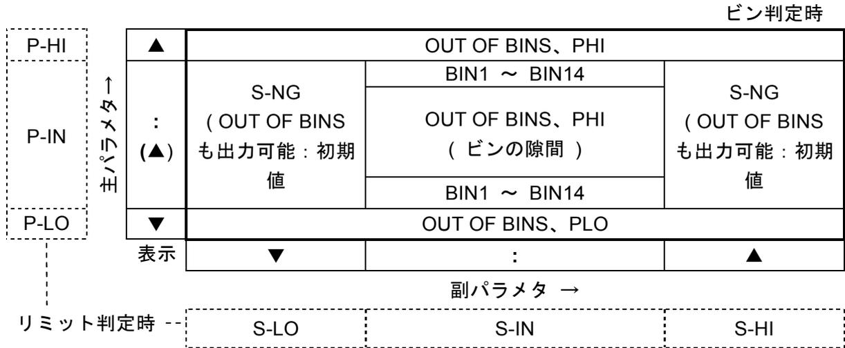
図 4-3 コンパレータの判定結果出力
