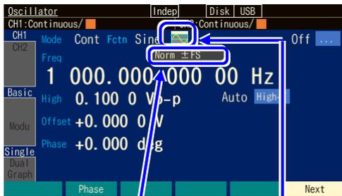
極性／振幅範囲のアイコンを選択すると現在の極性／振幅範囲が表示されます
