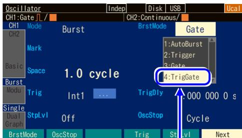
[BrstMode] で [TrigGate] を選択し、ENTER キーを押します
