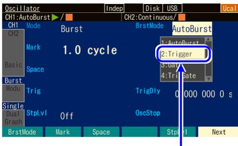
[BurstMode] で [Trigger] を選択し，ENTER キーを押します
