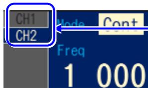
Oscillator 画面のタブ領域上端に現在のアクティブなチャンネルが表示されます
