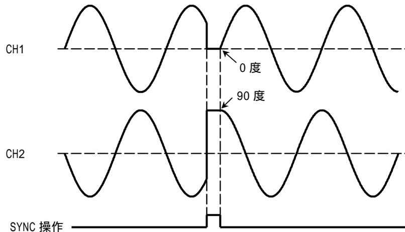
チャンネルモードが INDEP のときの位相同期操作と CH1、CH2 の波形出力 (CH1 の位相 = 0 度、CH2 の位相 = 90 度のとき)
