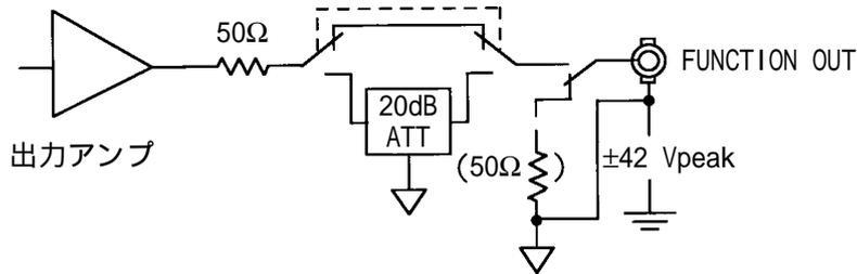
最大出力電圧 : 20Vp-p / 開放時、10Vp-p / 50 負荷時
