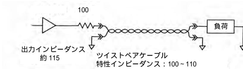
送り側のインピーダンスと、伝送線路の特性インピーダンスは、ほぼ整合しているため、負荷開放でも比較的良好な波形が得られます。
