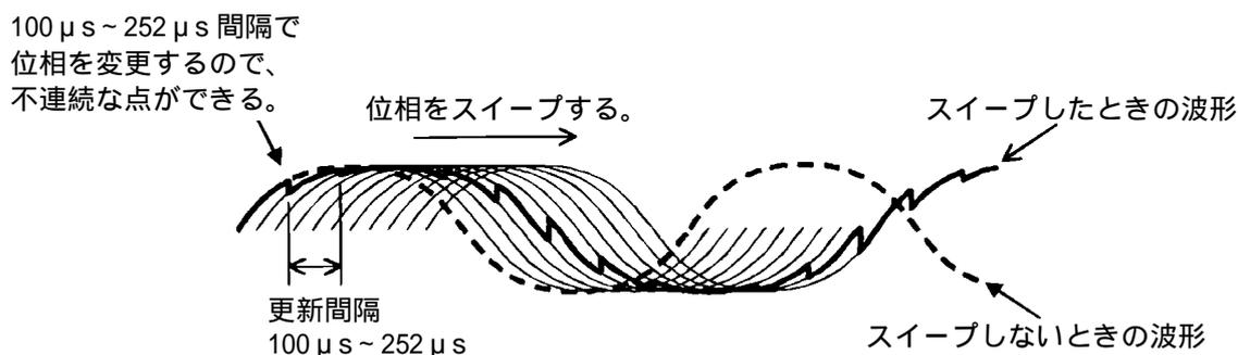
「L」 方形波（デューティ固定）と、「L」 方形波（デューティ可変）は、その他の波形と生成方法が異なるために、余分なパルスが発生します。
