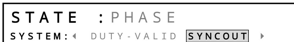
キーを押し、、 キーで SYNC OUT の波形を設定します。
