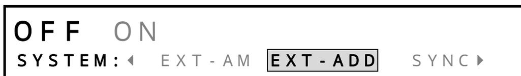
次に <sup>ENTER</sup> キーを押し、◀、▶ キーで下記の状態 (ON が点滅) にします。
