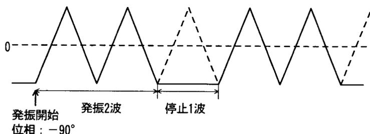
※更に、振幅 (Vp-p) の  $\frac{1}{2}$  の DC オフセットを設定するが、あるいはローレベルを 0V に設定すると、片極性の波形が得られます。
