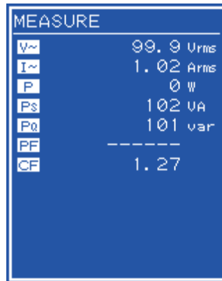
図 3-12 計測値ウインドウ（AC-INT モード時）の表示例
