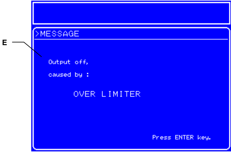
Figure 4-2. LCD Screen (Warning Display)
