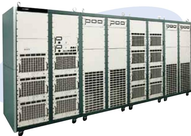
本システムは、スイッチング方式・パワーアンプ回路の採用により小型化を実現した大容量交流電源です。最大出力は 240kVA、DC～3kHz の広帯域で、波形ひずみ、電圧変動や周波数変動の小さい高品位な出力を得られます。非正弦波や直流・交流重畳なども可能で、各種試験に対応します。
