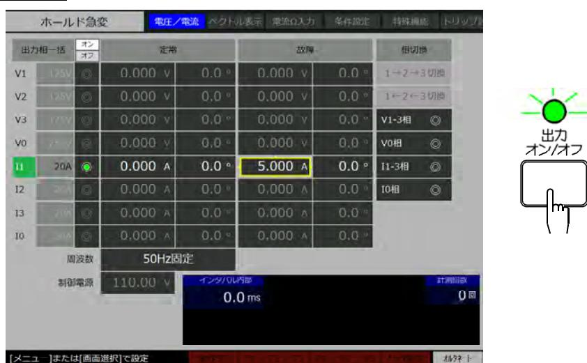
6. [動作指令]を押すと、定常から故障状態に急変し故障表示 LED が点灯し、過電流リレーの動作試験が始まります。
