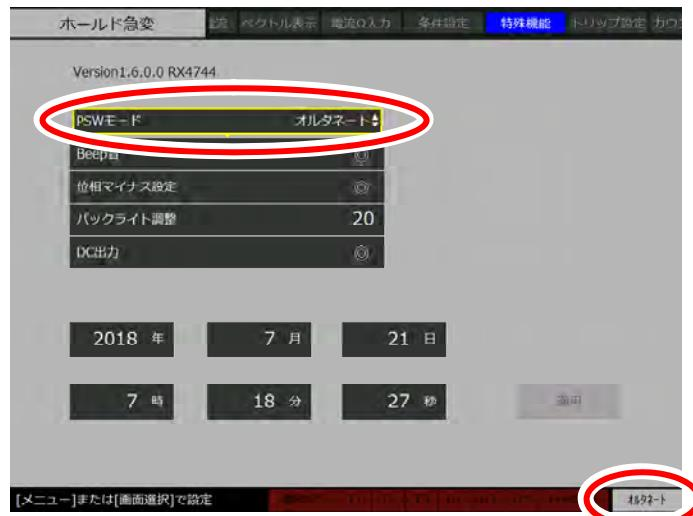
モーメンタリを選択すると、**動作指令**を押している間だけ試験動作が実行されます。そのため試験動作中に異常を感じたら直ちに試験動作を中止することができるようになります。画面右下のPSW表示に“モーメンタリ”と表示されます。
