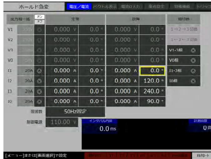
2. シフト+電流反転を押すと電流反転が働き、故障電流の位相が反転（ $180^\circ$  回転）します。さらにシフト+電流反転を押すと、電流反転が働き元に戻ります。
