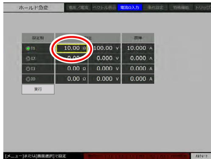
4. [実行]を押すと、故障電流値が計算されます。故障電流の欄に  $10.000\text{ A}$  が表示されます。
