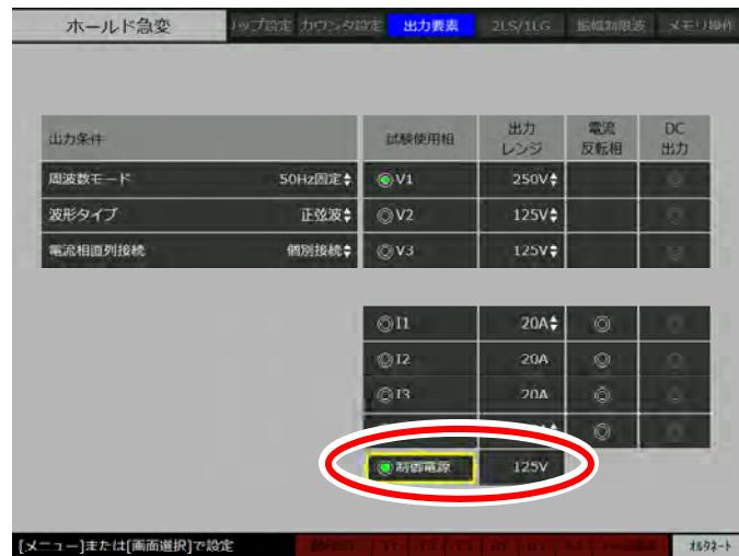
3. 制御電源出力の振幅を設定するには **3.4.5 振幅・位相・周波数の設定方法**を参照してください。
