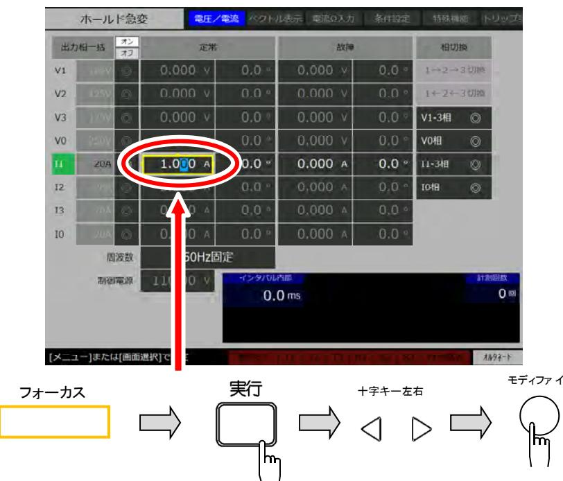
画面下のトリップ1(T1)表示をモニタリングしながら、振幅値をゆっくり上げていくと過電流リレーが動き出し、T1が点灯します。そのときの振幅値が動作値です。その状態から今度は逆にゆっくり振幅値を下げていくと、T1が消灯します。そのときの振幅値が復帰値です。
