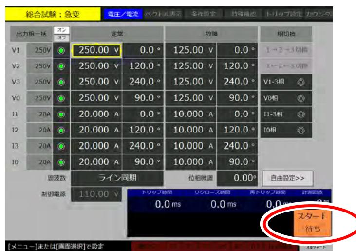
“動作スタート信号待ち”かつプリトリガ時間機能が有効の本器に動作スタート信号を入力すると、動作スタート信号からプリトリガ時間後に定常から故障に急変し、試験シーケンスを開始します。
