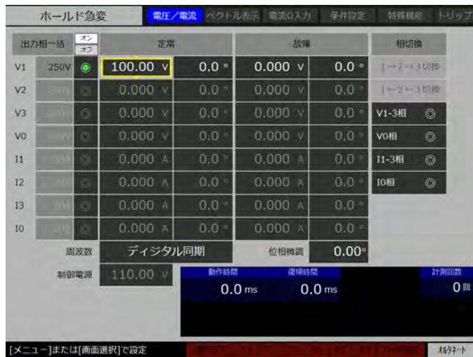
3. 同様にして、本器①の動作モードを“ホールド急変”にし、本器①の【出力要素】画面で周波数モードを“内部可変”に選択します。ここで例として V1 相を出力するために、同画面の試験使用相の V1 相を有効にしておきます。
