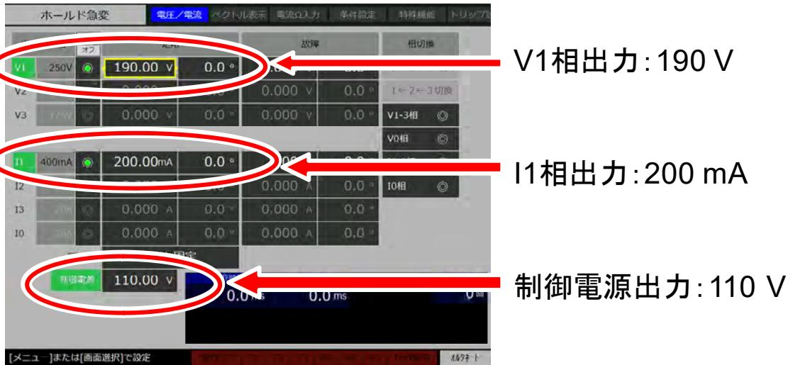
5. 電圧 1 相出力 (V1) を AC 190 V,  $0.0^\circ$  , 微小電流出力を 200 mA に固定したまま、微小電流出力の位相だけを変化させます。微小電流出力の位相を変化させる方法は **3.4.5 振幅・位相・周波数の設定方法**を参照してください。
