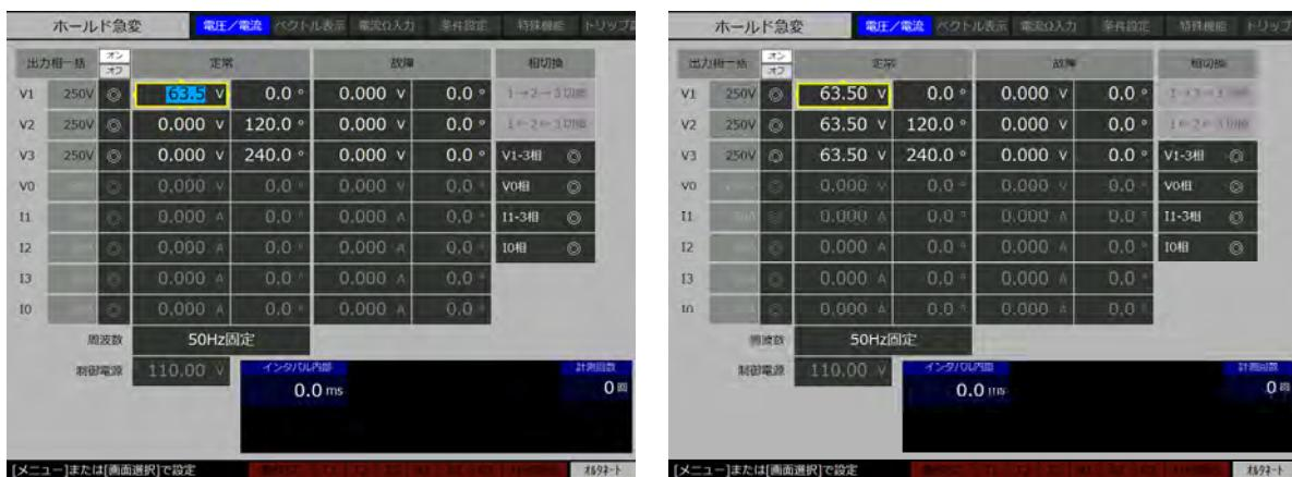
3. 位相にフォーカスを合わせ、位相値を入力し**実行**を押します。以下は  $120^\circ$  ずつ位相がずれた V1～V3 相に対して、V1 相の位相に  $30^\circ$  を入力した例です。
