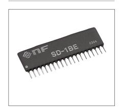
ハイブリッドIC化されたローパワー型1次対バンドエリミネーションフィルタです。 ディジタル制御によりFILTモードとTHRUモードが選択でき、さらにFILTモードでは中 心周波数が50Hzまたは60Hzに設定可能となっています。ここでの減衰量は、中心周 波数から±1%離れた周波数においても24dB以上に管理されています。
