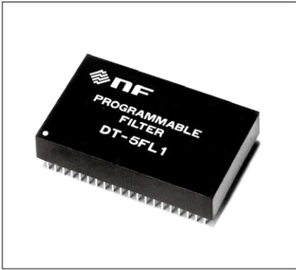
DT-5FL/6FLは、特にA/D変換時のアンチエイリアシング用に開発された急峻なローパスフィルタです。デジタル信号で遮断周波数を8点切換えできるので、サンプリング周波数をたびたび変更する用途に最適です。
