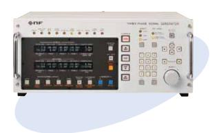
スマートグリッドなど再生可能エネルギーを接続した 新しい電力系統のシミュレーション、開発などに使用 できる三相発振器です。
