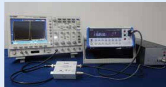
オシロスコープの測定例 C/Vコンバータの出力にデジタルマルチメータを接続して、直流電圧値を容量値に変換します。
