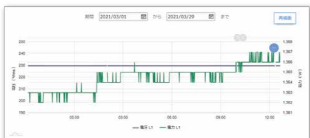
出力電圧 / 電力の時間推移グラフ
