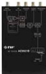
AEテストは、プリアンプ、フィルタ、ディスクリミネータ、レートメータの機能を小型ケースにまとめた簡易型AE計測器です。ハンディチェッカとして便利です。
