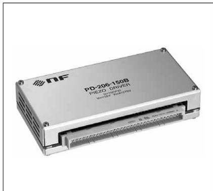
PD-206-150P/Bは、各種圧電アクチュエータ( Pieゾ)の駆動用に最適な150Vp-pを出力するリニアアンプ式のモジュールです。150P型は0~+150Vタイプ、150B型はバイモルフ型にも使用できるバイポーラ ±75Vタイプです。どちらのタイプもピーク電流対応型保護回路により、大容量負荷の突入電流にも対応します。電源は小さな本体に内蔵されており、低電圧の片電源で作動し、しかも低雑音です。
