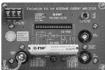
機器への組み込み用としてプリント基板に実装する前に、特性を評価するためのキットです。
