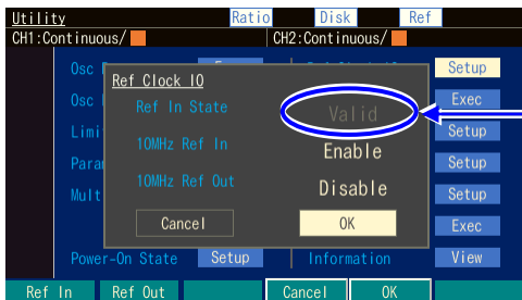
利用可能な周波数基準が入力されていれば、[10MHz Ref In]の欄に[Valid]と表示されます。そうでない場合は[Invalid]と表示されます。
