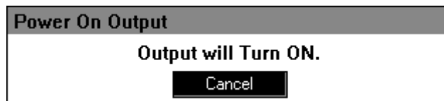
図4-24 電源投入後、自動的に出力オンする前に表示されるメッセージウィンドウ
